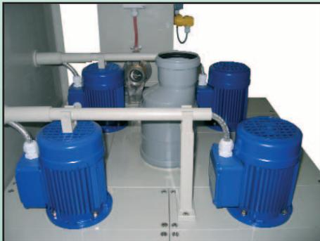
Prozess- und Spülbäder werden in voneinander getrennten Reaktoren behandelt, um eine Verschneidung von Aktivbädern und Spülwässern zu vermeiden.
